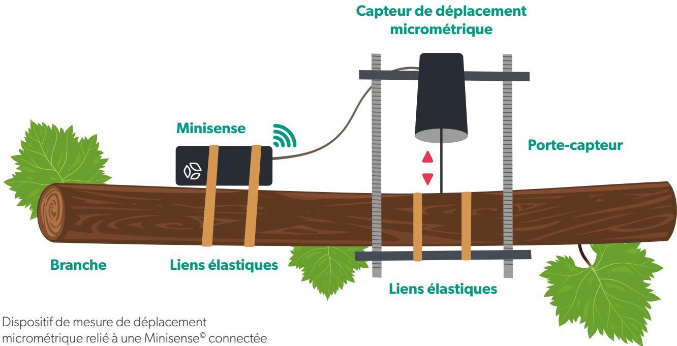
Dispositif de mesure de déplacement micrométrique relié à une Minisense® connectée pour le **Suivi Dendrométrique**.
